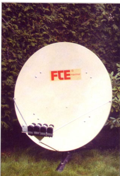
120-cm-Multifeedantenne von FTE Maximal Mayer mit vier bestückten LNB-Plätzen für den Parallelempfang von bis zu fünf Satelliten
